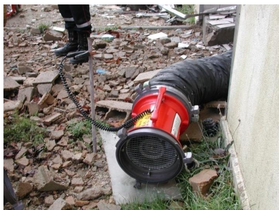
Illustration n°2 : Utilisation d'un hydro ventilateur
