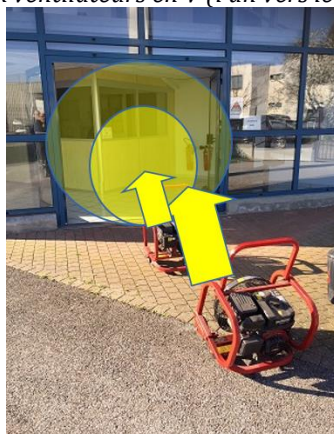
Illustration n°5 : Utilisation de deux ventilateurs l'un derrière l'autre
