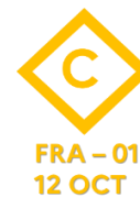
Peut correspondre à la fin du déblai sélectif (MGO 5), indiquant que la zone est dégagée de toutes victimes vivantes et décédées
