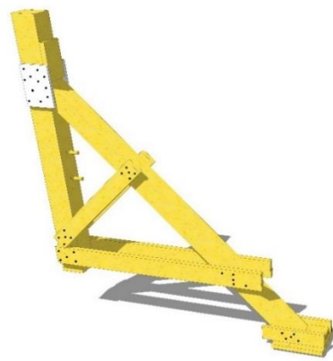
Étai latéral triangle avec encombrements © Guillaume Vermeulen – SDIS 59
