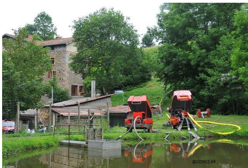
Illustration n°5 : Alimentation de deux lignes de 110 à partir de motopompes (Crédit photo @ SDMIS 69)
