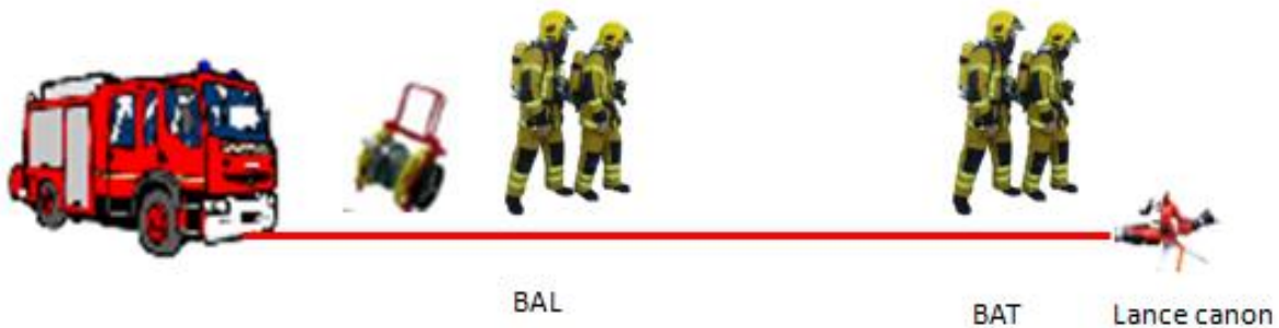
Illustration n°1 : Schéma de principe d'établissement d'une lance canon
