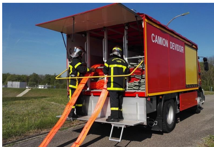
Illustration n°8 : Utilisation d'un dévidoir automobile (Crédit photo @ SDIS 38)
