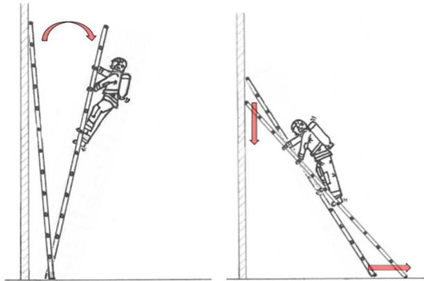
Pour être stable, l'échelle ne doit être ni trop développée, ni trop inclinée ; aussi le pied de l'échelle doit être éloigné du mur d'environ 1/3 de la longueur développée.
