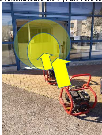
Illustration n°5 : Utilisation de deux ventilateurs l'un derrière l'autre
