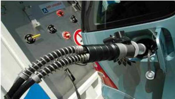
Figure 2: remplissage d'une voiture H<sub>2</sub>
