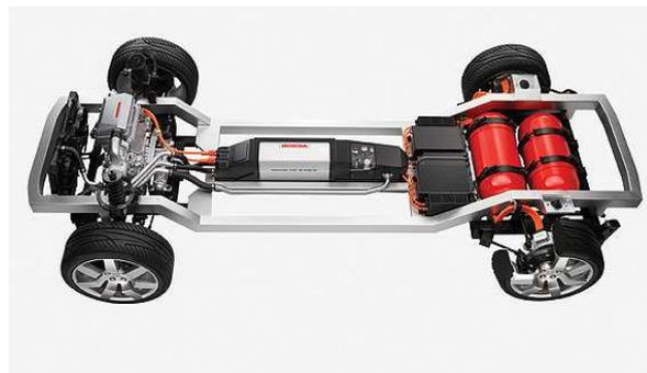
Schéma 1: Schéma de principe d'une voiture H<sub>2</sub>
