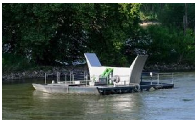
Hydrolienne sur la Loire (Loiret)
